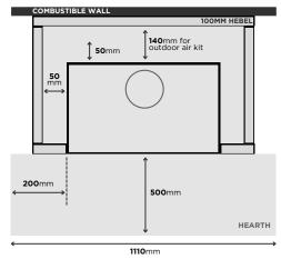
\*\*\*HEARTH MUST BE A MINIMUM OF 150MM THICK
